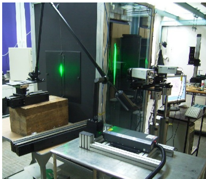
Rys. 3.3.3: Układ doświadczalny z systemem Stereo-PIV. Na pierwszym planie widoczny laser impulsowy. Wiązka laserowa jest kierowana do szczeliny w komorze wykorzystując tzw. ramię świetlne. Płaszczyzna świetlna tworzona przez zastosowanie układu optycznego z soczewką cylindryczną oświetla wnętrze komory, w której zachodzi badany proces mieszania. Przed komorą widoczne są kamery w ustawieniu stereoskopowym oraz komputer sterujący systemem i archiwizujący dane.
