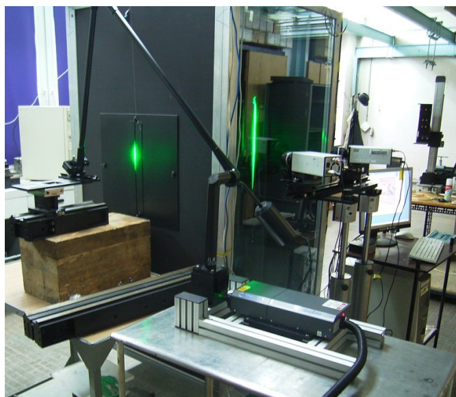
Rys. 4.6.3: Układ doświadczalny z systemem Stereo-PIV. Na pierwszym planie widoczny laser pulsacyjny. Wiązka laserowa jest kierowana do szczeliny w komorze przez ramię świetlne. Płaszczyzna świetlna tworzona przez zastosowanie układu optycznego z soczewką cylindryczną oświetla wnętrze komory, w której zachodzi badany proces mieszania. Przed komorą widoczne kamery w ustawieniu stereoskopowym oraz komputer sterujący systemem i archiwizujący dane.
