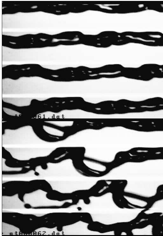
Rysunek 3.4: Propagacja zaburzeń powierzchni parującej strugi alkoholu zarejestrowana techniką „Frame-Transfer“. Czas narasta od górnego zdjęcia, interwał czasowy 19,6\mu s , r_j = 0,1mm , P_\infty = 100Pa , X = 0 .
