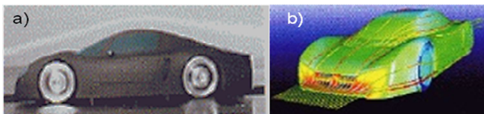
Rys. 10. Model samochodu Opel Eco Speedster badany w tunelu aerodynamicznym a) i obraz opływu samochodu w skali 1 : 1 otrzymany metodą modelowania komputerowego[15]
